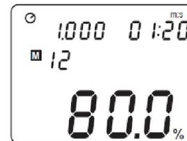
I. Remova o material de amostra e confirme se o medidor retorna para 100.0%. Se o medidor não exibir 100.0% com a amostra removida, então, esqueça a leitura e recomece o processo de teste.
